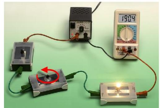
**L'intensité du courant dans un circuit en série ne dépend pas de l'ordre des dipôles branchés.**
