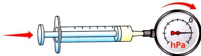
Mesure de la pression avec piston enfoncé
