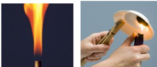
La quantité de dioxygène est **insuffisante** pour brûler complètement le méthane, la combustion est dite **incomplète**. La flamme est **jaune**. On observe un dépôt noir, c'est du **carbone**. Il se forme également un gaz inodore et très toxique : le **monoxyde de carbone**.
