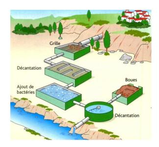
La <u>grille</u> repose sur le principe de la filtration : elle permet de retenir les déchets dont la taille est supérieure à celle de la « grille ».
