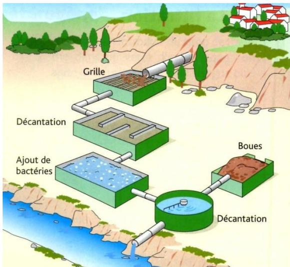
La grille repose sur le principe de la filtration : elle permet de retenir les déchets dont la taille est supérieure à celle de la « grille ».
