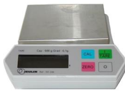
Tarer la balance il doit s'afficher 0.00 g
