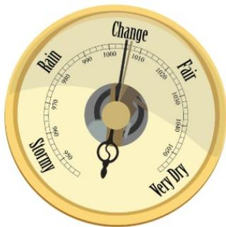
Un baromètre mesure la pression atmosphérique : c'est-à-dire la pression exercée par l'air de l'atmosphère, dont l'unité est l'hectopascal (hPa). La valeur mesurée dépend de l'altitude à laquelle le baromètre se trouve. Ce dernier est aussi utilisé pour prévoir la météo.
